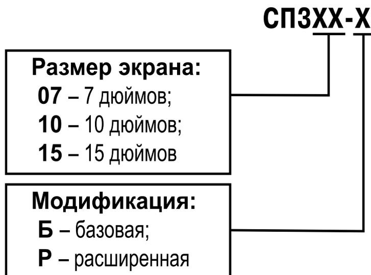
Условное обозначение панели оператора при заказе **СП310-Р** означает, что поставке подлежит панель оператора с сенсорным экраном размера 10 дюймов расширенной модификации.
